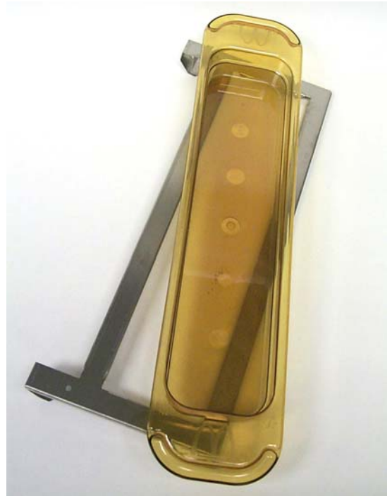
烧烤架夹子安装在烧烤架上，用于盛放 UHC-HD 托盘中的烧烤食品，便于将食品转移到保温柜中。
